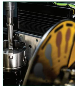
全自动化机器人手臂装载 全天候自动化扫描得益于可编程的样品切换和滤片切换模块
